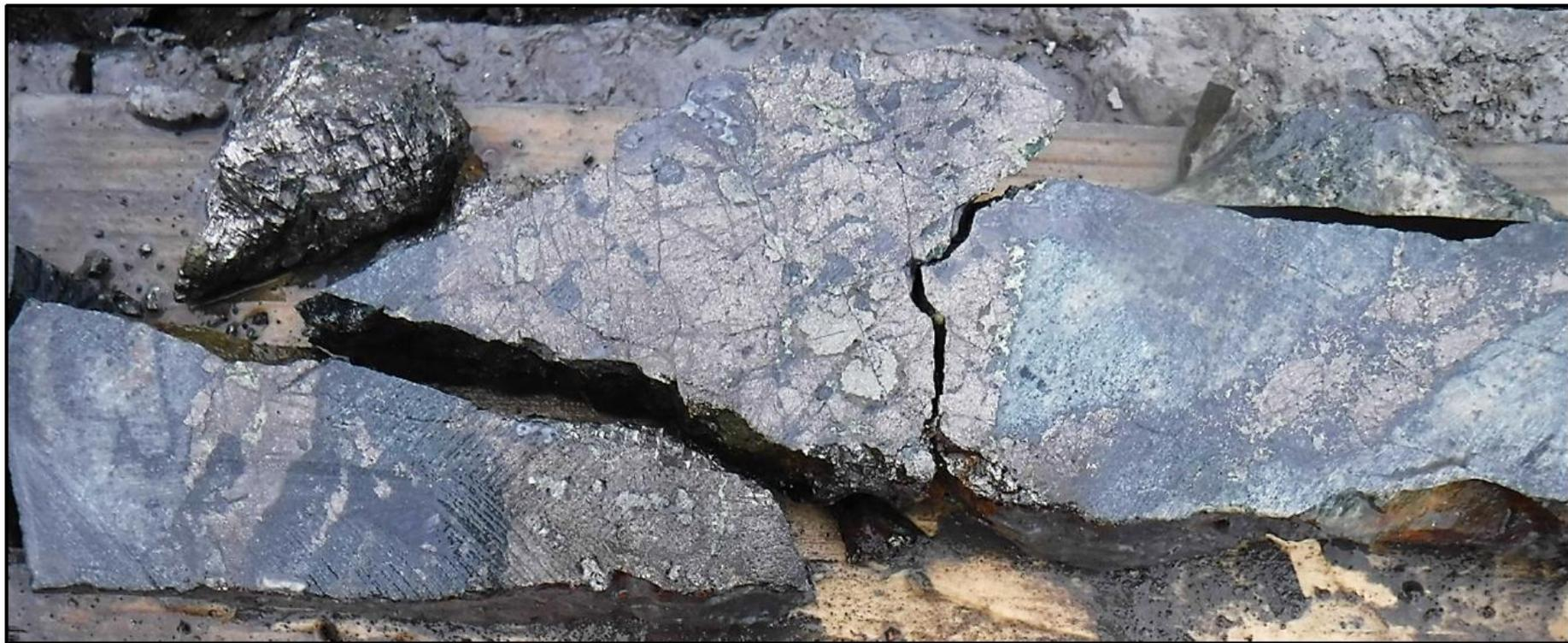
Figure 26: Exemple de minéralisation massive rencontrée dans les tranchées de Papavoine. Pyrrhotite massive avec des amas de chalcoppyrite à l'intérieur.
