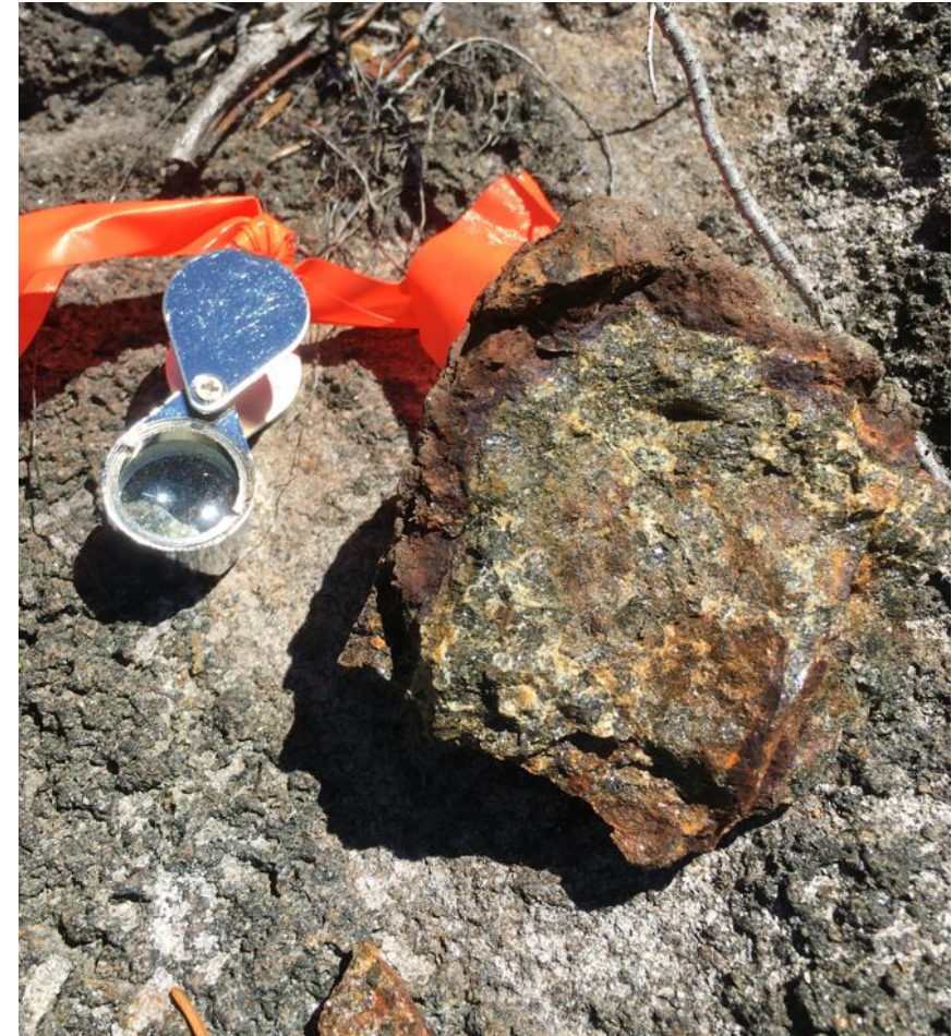
Anomale en Ni-Cu avec teneur élevée à 100% sulfides (5% Ni)
