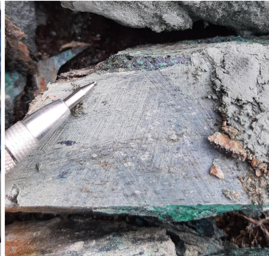
(c) Rainure 2, #C879224 : 1,17 % Cu, 0,56 g/t Au, 8,8 g/t Ag sur 0,5 mètres
