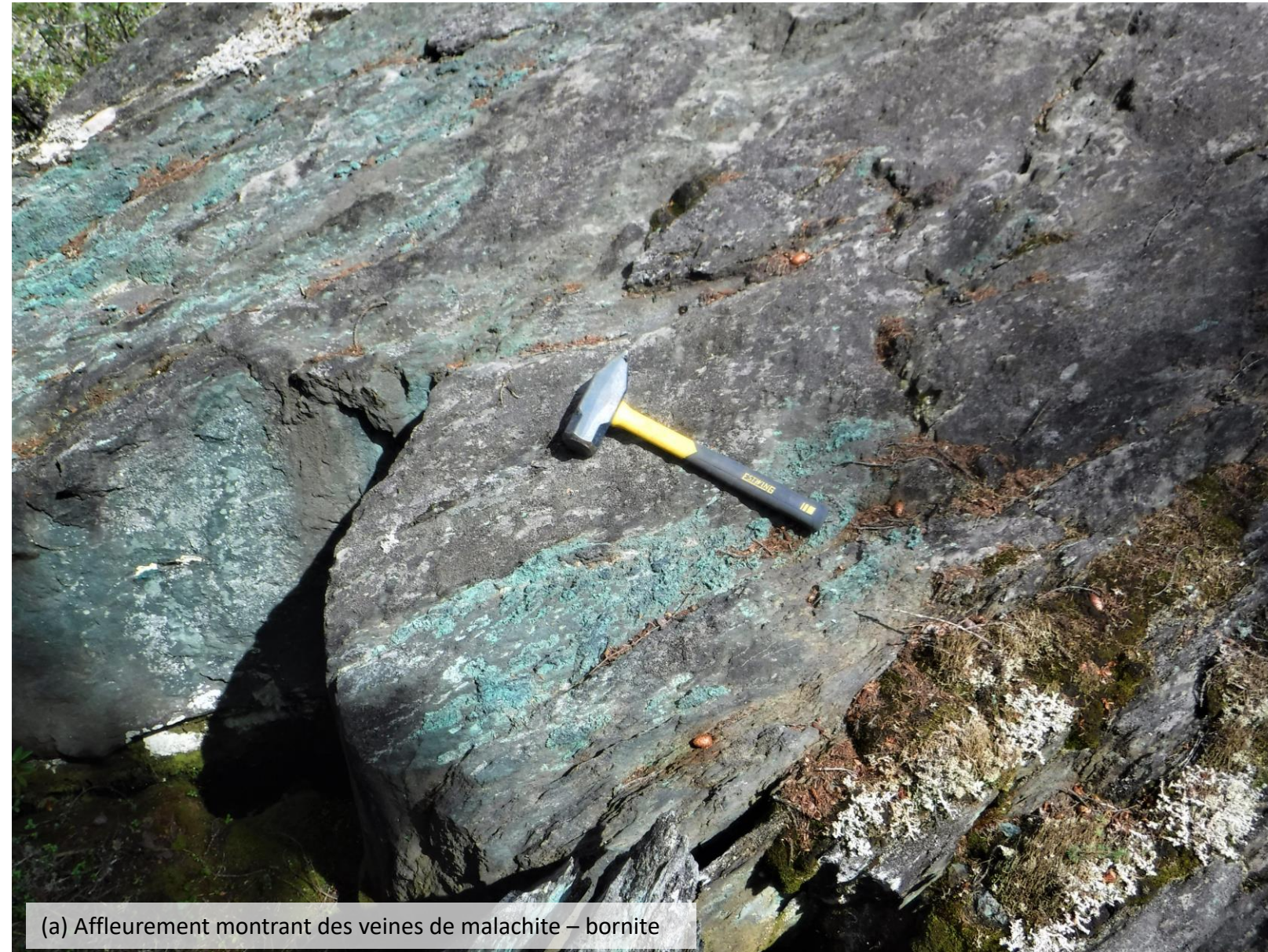
(b) Veines de malachite – bornite à la surface
