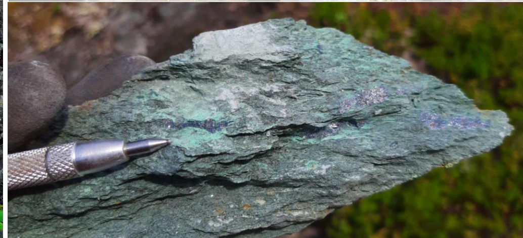
(c) #C878500 – Minéralisation à 3% de malachite et de bornite dans un schiste mafique
