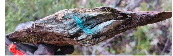
0,41 % Cu, 5,10 g/t Ag, 0,08 g/t Au amas cm de malachite sécant dans la schistosité du schiste à chlorite (#C1456413)
