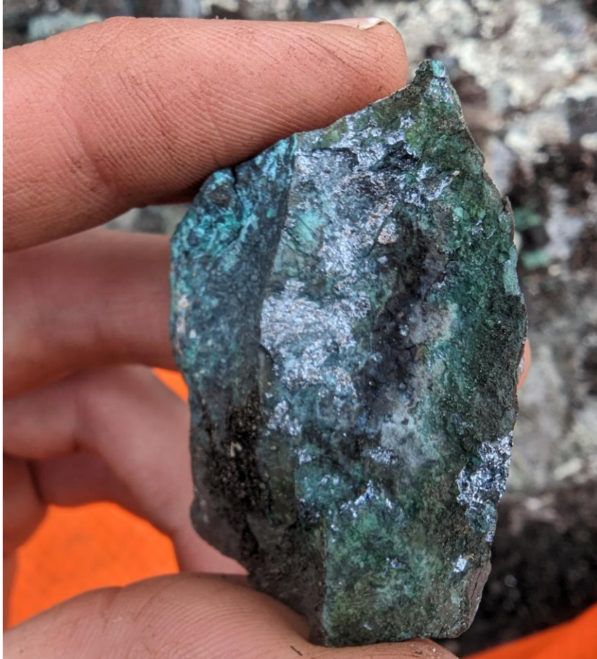
39,90 % Cu, 308,00 g/t Ag, 0,04 g/t Au Bornite, digénite, malachite massive dans une veine dm de calcite (#C1456513 )
