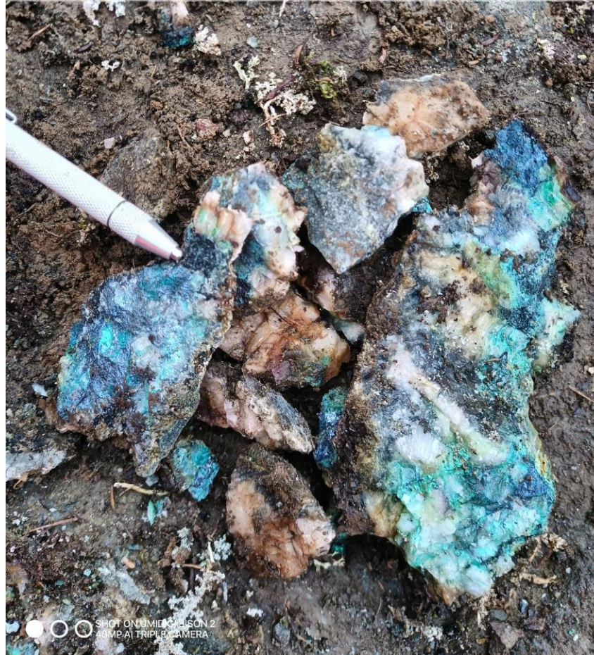
23,90 % Cu, 238,00 g/t Ag, 1,40 g/t Au veine de calcite, digénite, malachite, bornite cm (#C1456119)
