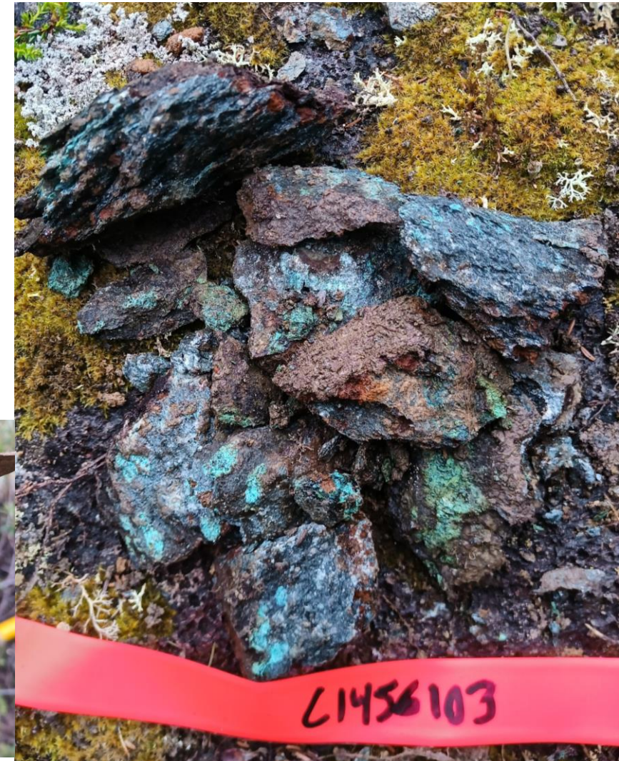
#C1456103 : schiste ultramafique à ankérite, 15% malachite, 1% bornite dans la schistosité
