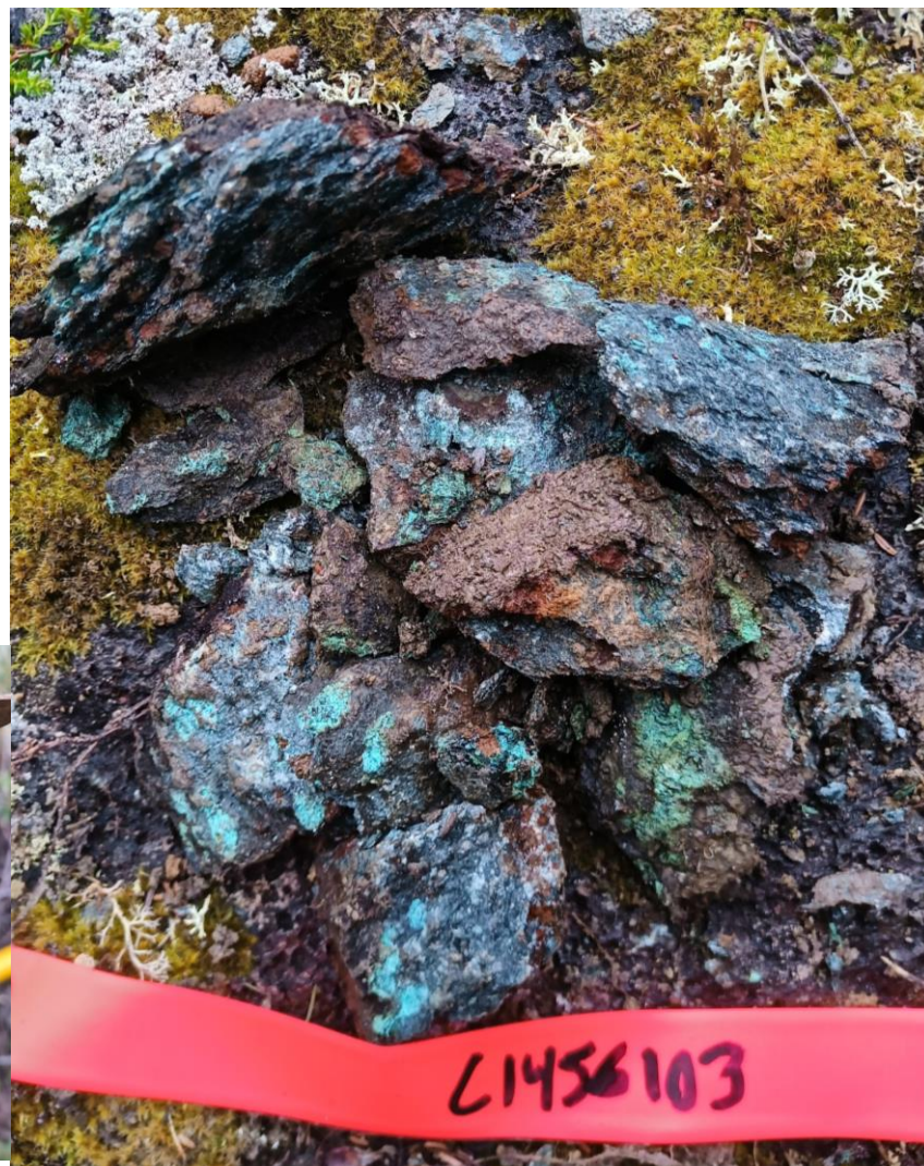
#C1456103 : schiste ultramafique à ankérite, 15% malachite, 1% bornite dans la schistosité
