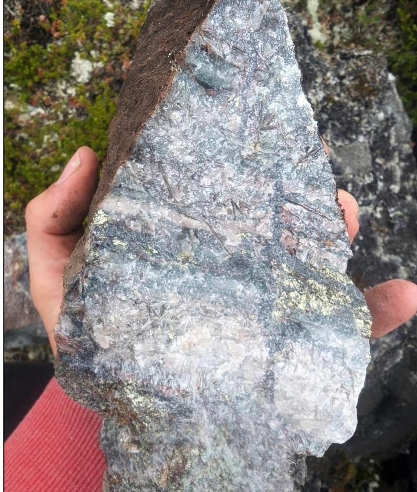
C1456050. Bloc de tuf mafique lité avec altération calco-silicatée à actinote (type skarn) et minéralisation en chalcopryrite-magnétite automorphes. **1,14 % Cu** (échantillon choisi).
