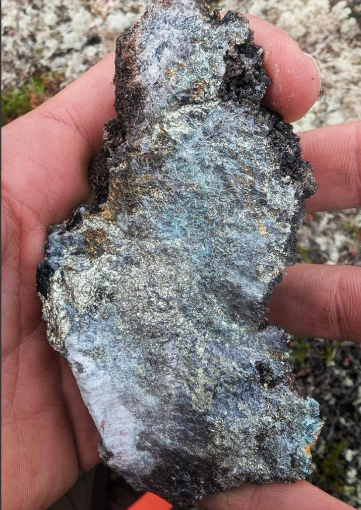
C1456560. Même bloc de dolomie avec forte altération calco-silicatée à trémolite (type skarn) et minéralisation pervasive en chalcopryrite-magnétite. **1,75 % Cu** (échantillon choisi).
