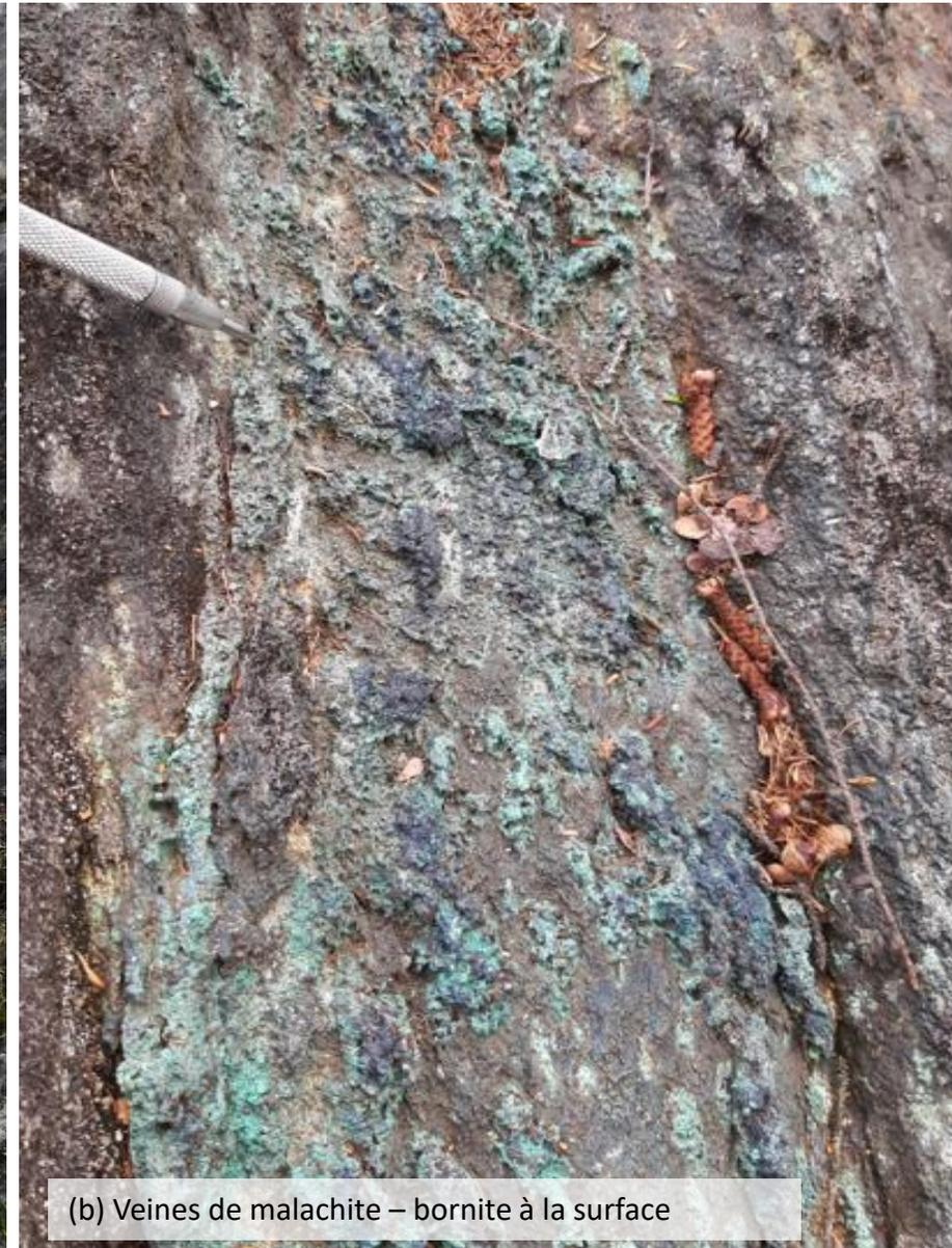
(b) Veines de malachite – bornite à la surface
