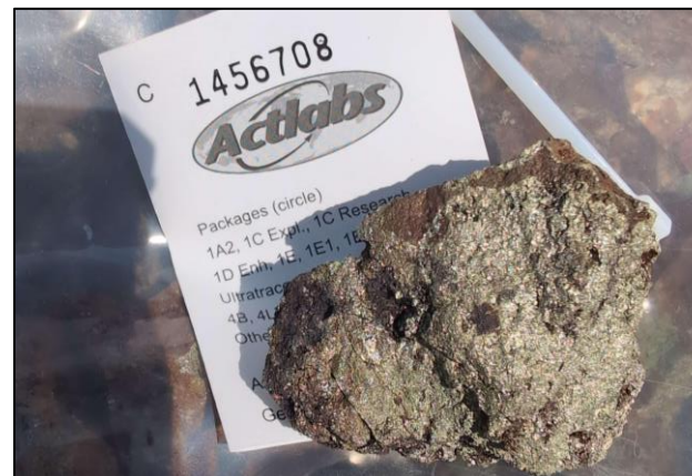
◀ #C1456708 : 31,60 % Cu, 6,92 g/t Au, 0,16 % ETR, 0,20 % Co, 37,30 g/t Ag Horizon massif riche en chalcoppyrite, malachite et azurite
