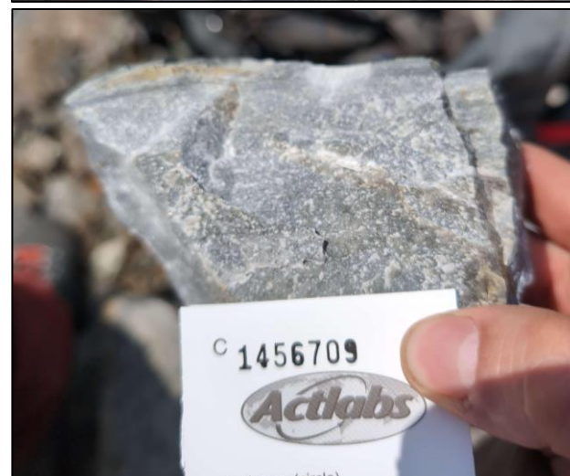
▲ #C1456709 : 0,39 % ETR, 0,65 % Cu, 0,05 g/t Au, 0,008 % Co, 1,20 g/t Ag Siltstone minéralisé à 3% chalcoppyrite et fortement carbonaté
