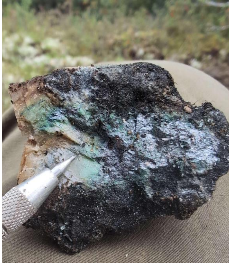
#C2130509 : 9,97% Cu, 2,40 g/t Au, 61,40 g/t Ag Amas de digénite centimétrique dans une veine de calcite
