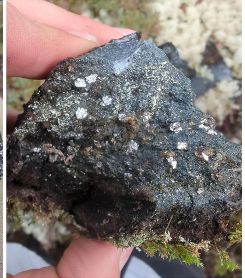
#C2130608 : 4,66% Cu, 0,20 g/t Au, 13,80 g/t Ag Minéralisation en pyrite et chalcopyrite disséminée dans une roche ultramafique
