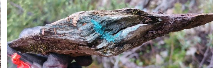
0,41 % Cu, 5,10 g/t Ag, 0,08 g/t Au amas cm de malachite sécant dans la schistosité du schiste à chlorite (#C1456413)
