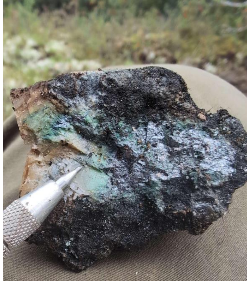
#C2130509 : 9,97% Cu, 2,40 g/t Au, 61,40 g/t Ag Amas de digénite de la taille d'un centimètre dans une veine de calcite
