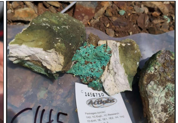
▲ #C1456710 : 12,30 % Cu, 0,36 g/t Au, 0,57 % ETR, 0,02 % Co, 6,60 g/t Ag Veine de calcite et de malachite
