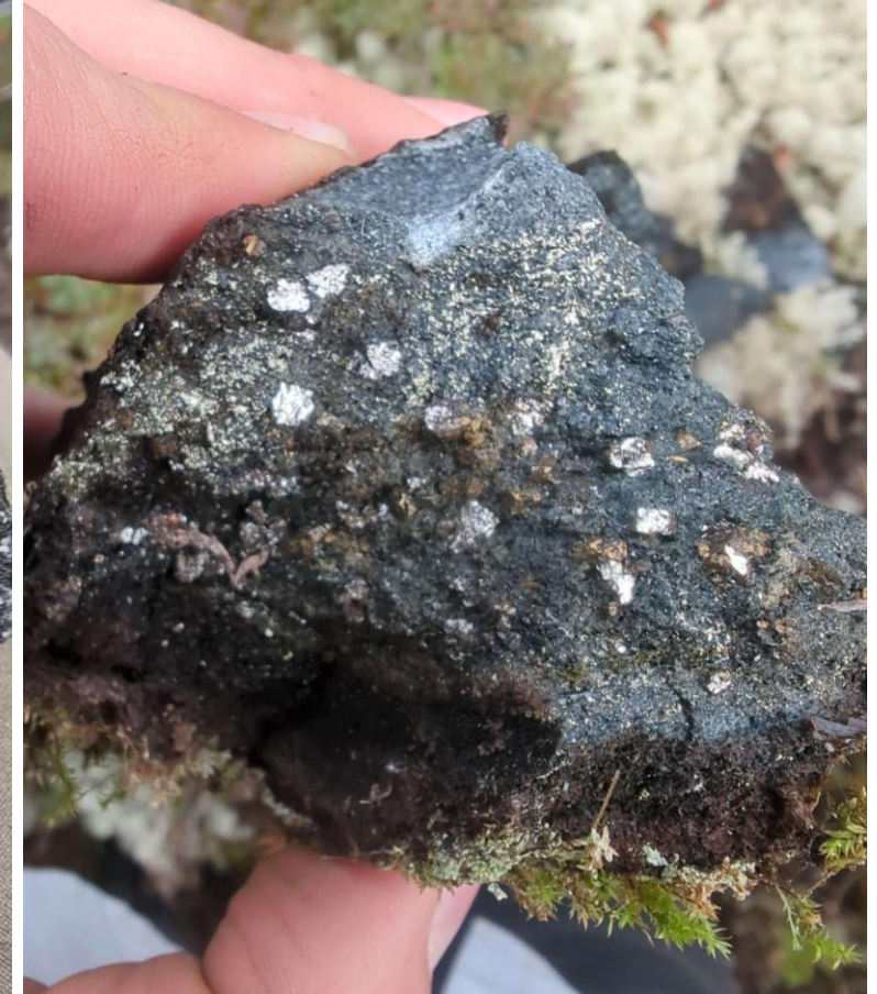
#C2130608 : 4,66% Cu, 0,20 g/t Au, 13,80 g/t Ag Minéralisation de pyrite et de chalcoppyrite disséminée dans une roche ultramafique
