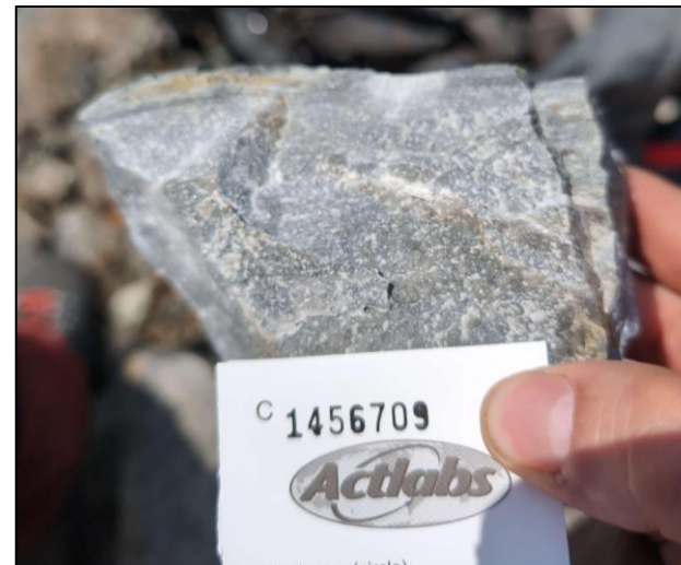
▲ #C1456709 : 0,39 % ETR, 0,65 % Cu, 0,05 g/t Au, 0,008 % Co, 1,20 g/t Ag Siltite minéralisée à 3 % de chalcopryrite et fortement carbonatée
