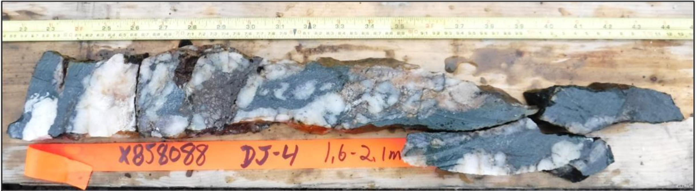
Figure 12 : Exemple de la zone minéralisée de Didgeridoo, fortement altérée en chlorite, avec de petites veines de quartz rouillées et des plages de pyrrhotite contenant des traces de chalcoppyrite. DJ-18-04 de 1,6 à 2,1 m, X858088 : 2,62 g/t Au.
