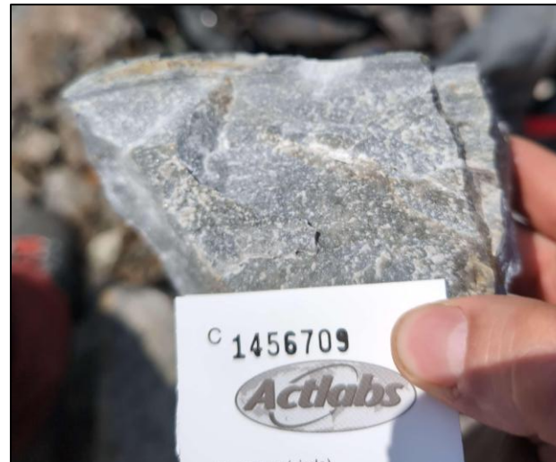
▲ #C1456709 : 0,39 % ETR, 0,65 % Cu, 0,05 g/t Au, 0,008 % Co, 1,20 g/t Ag Siltstone minéralisé à 3% chalcopryrite et fortement carbonaté
