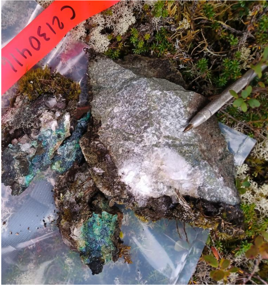
#C2130416 : 13,70% Cu, 4,83 g/t Au, 28,60 g/t Ag Amas de digénite et malachite dans une veine de quartz et calcite au sein d'un encaissant mafique fortement altéré en épidote, albite
