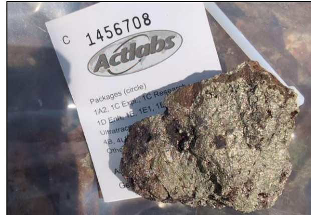
◀ #C1456708 : 31,60 % Cu, 6,92 g/t Au, 0,16 % ETR, 0,20 % Co, 37,30 g/t Ag Horizon massif riche en chalcopryrite, malachite et azurite
